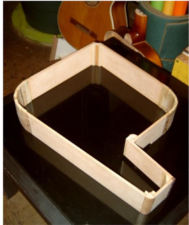
Hier die Zarge spiegelverkehrt auf dem Kopf liegend, so wie es für die gesamte Arbeit unumgänglich ist. Erfordert die Logistik des Zusammenbaus. Rechts im einzigen Innenknick, siehst Du oben im Verlauf der Zarge eine Aussparung für den Hals - hier im Bild natürlich unten.
