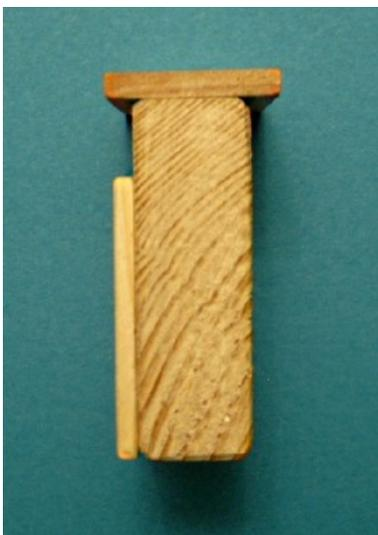
Wenn man beide Seiten der Falz scharf und möglichst tief eingeritzt hat, sollte das Ausheben der Falz mit dem Beitel nur halb so kompliziert.
