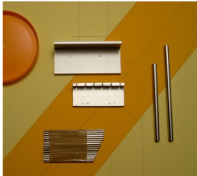
Die Stärke des Metallsägeblatts ist 0.7 mm und ich möchte, dass die Bündel an beiden Seiten je einen Millimeter vom Rand entfernt sind, also habe ich die obige Tabelle mit einem Untermaß für die Bündel mit 1.3 mm berechnet, plus 0.2 mm, weil das Sägeblatt nie 100% glatt am Anschlag entlangläuft. Ein frisches Sägeblatt frisst sich in Null Komma nix durch den härtesten Stahl.
