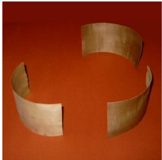
**1. Fehler:** Ich habe die Furnierstreifen nach dem Dampfbad mit Paketklebeband um den Topf gewickelt, um es in Form zu bringen. Durch die Verwendung des Paketklebebands kann das Holz nicht trocknen, weil es rundum von der Außenluft abgeschlossen ist.
